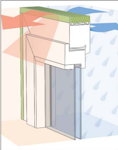
Brtvi na udare kiše, toplinski izolira i ne propušta zrak: illbruck TP652 illmod triplex +
