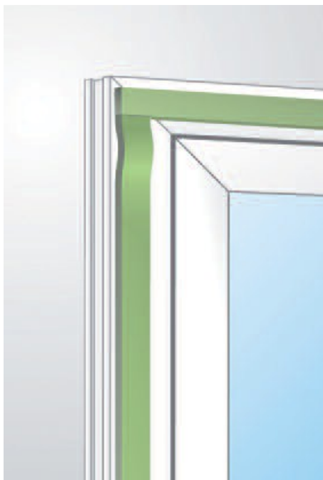
Kutno dimenzioniranje kod montaže prozora
