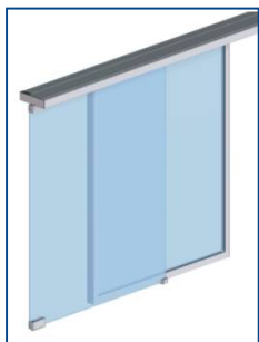
Zaštitno krilo Zaštita bočnih rubova za evakuacijska vrata a ugrađuje se na vrata na kojima nije dopuštena ugradnja sigurnosnih senzora ( vrata se moraju u svakom slučaju otvoriti)
